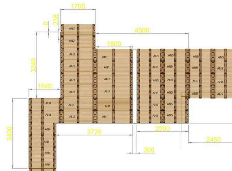
Réalisation d'un plan de calepinage d'un plafond avec des modules standards et des découpes à prévoir Logiciel CAO
